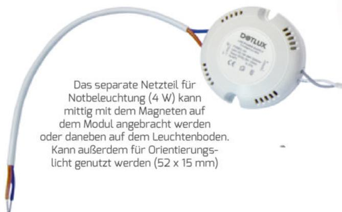
Das separate Netzteil für Notbeleuchtung (4 W) kann mittig mit dem Magneten auf dem Modul angebracht werden oder daneben auf dem Leuchtenboden. Kann außerdem für Orientierungslicht genutzt werden (52 x 15 mm)
